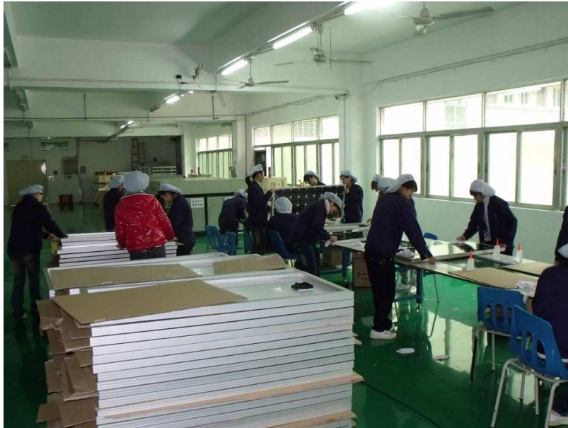
Figuur 6: Aluminium frames en aansluitdozen worden gemonteerd in een aantal kleine zonnepanelenfabriek in Shenzhen, China (bron: J. Verschelling).
