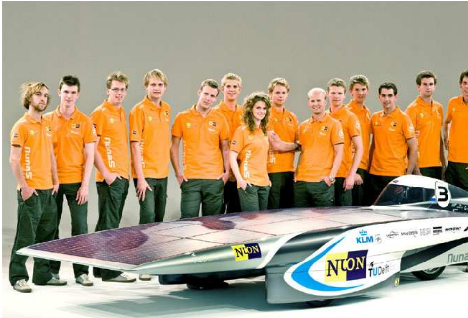
Figuur 4: De Nuna 5 racewagen op zonne-energie gebouwd door studenten van de TU Delft voor de World Solar Challenge (2009), 3000km dwars door Australië. De zonnecellen volgen de enigszins gebogen vorm van de Nuna en hebben een rendement van maar liefst 34%. (bron: http://www.solarwebsite.nl ). De Nuna haalt een topsnelheid van 145 km/h.
